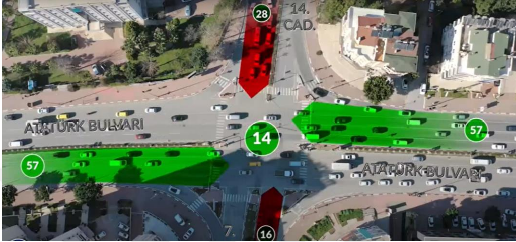
Şekil 4.89. Akıllı kavşak sistemi kuyruklanma boylarının azaltılması (URL-46, 2021)
